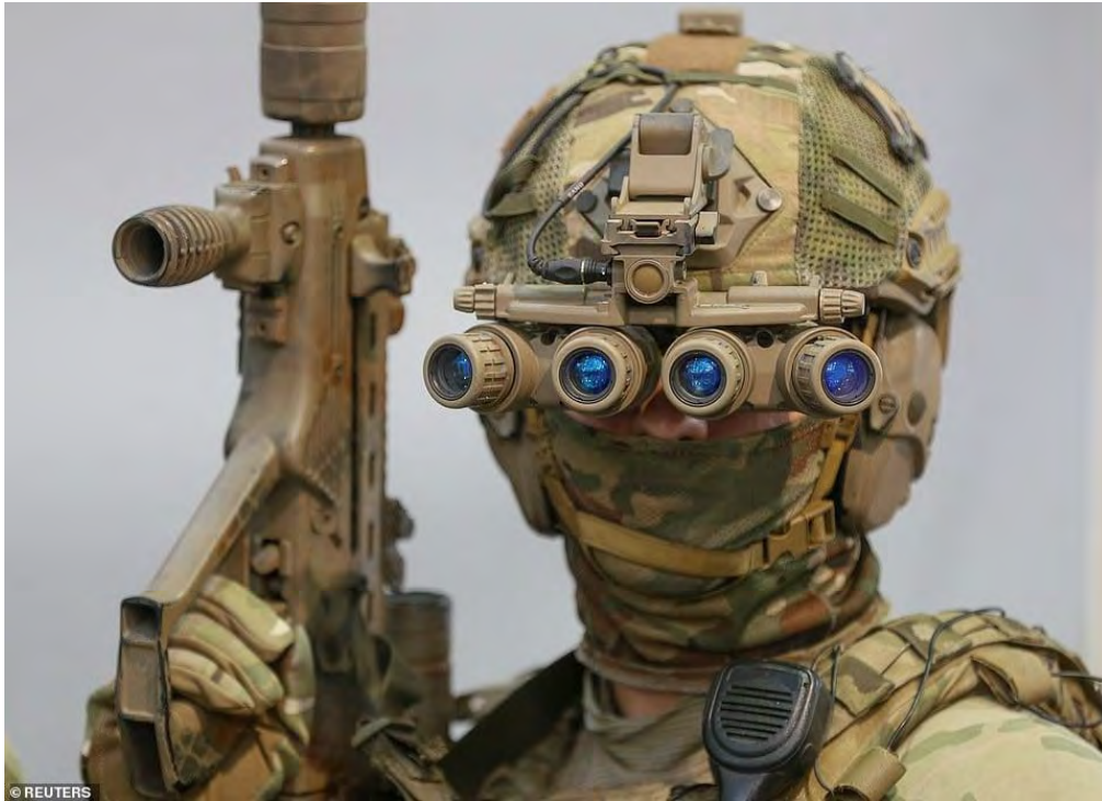
Biệt Kích Ukraine đeo máy nhìn đêm GPNVG-18 trị giá 40 ngàn đô la và nón chống đạn FAST của Mỹ. Toán 6 Navy SEAL đã đeo máy này khi đột kích tiêu diệt trùm khủng bố Osama bin Laden. GPNVG-18 nặng khoảng 700 gram hơn loại cũ GPNVG-15 chỉ 600gram nhưng có góc độ thấy rất rộng đến 97 độ.
